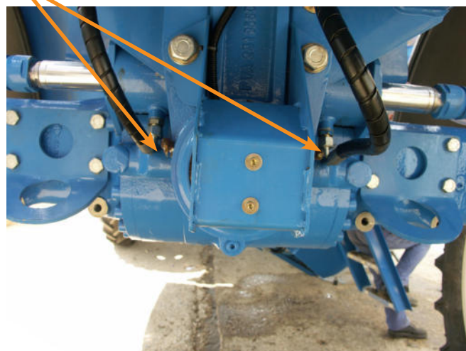
Palier pont avant
